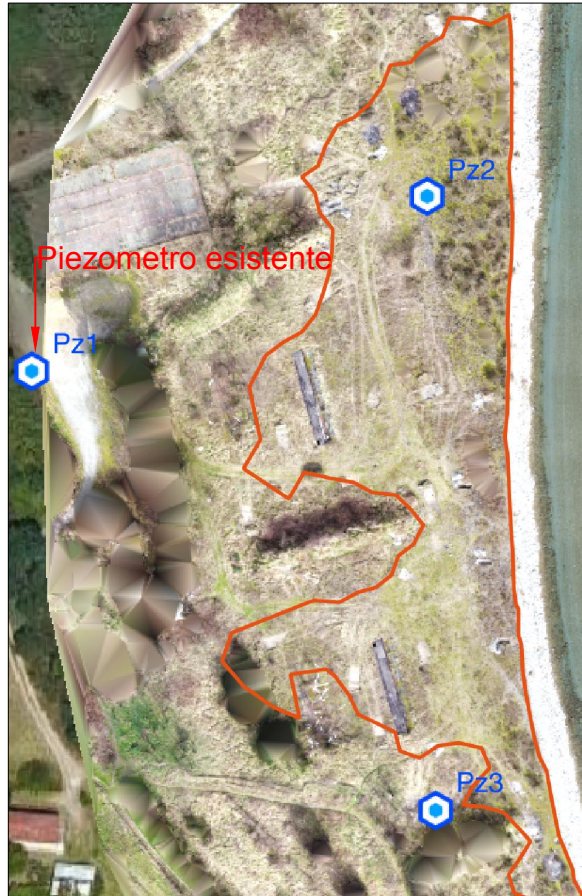
Ubicazione dei piezometri per il monitoraggio delle acque sotterranee
