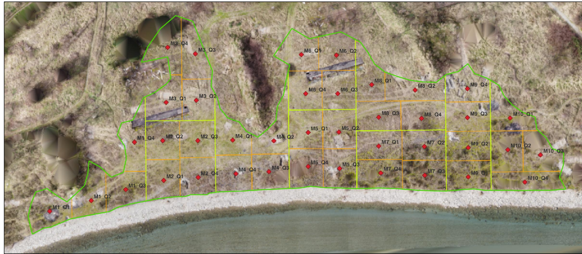
Ubicazione dei piezometri per il monitoraggio delle acque sotterranee
